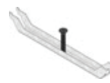
Knebelset für FIBRETEC Design Stegrost, verzinkt, inkl. Schraube (2 Sets pro lfdm. notwendig), verwendbar ab Bauhöhe 75 mm
