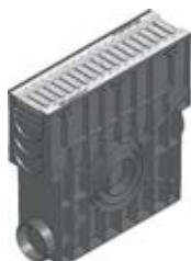
Avaloir avec panier PVC et grille passerelle à fentes 75x9, agrée passage VL, montée et clavetée
