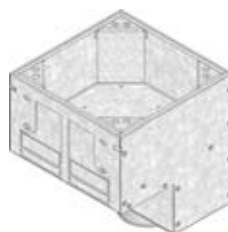
Regard d'évacuation pour types 100 et 150, avec réceptacle amovible
