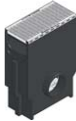
Avaloir avec panier galva et grille caillebotis, mailles 30x10, classe B 125, montée et clavetée
