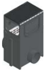
Avaloir avec panier galva, raccordement latéral DN 200 ou DN 315, et grille GUGI caillebotis fonte, mailles 15x22, noire, classe C 250, monté et claveté
