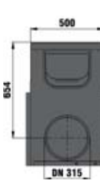
Avaloir, vue détaillée
