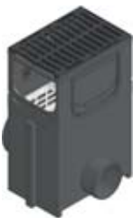
Avaloir avec panier galva, uniquement pour caniveau type 01, raccordement latéral DN 200, et grille fonte, à fentes 2x127x18 mm, noire, classe B 125, montée et clavetée
