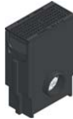
Avaloir avec panier galva et GUGI caillebotis fonte 15x22, noire, classe C 250, montée et clavetée
