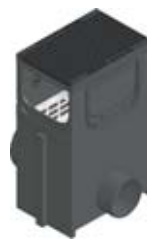
Avaloir avec panier galva, uniquement pour caniveau type 01, raccordement latéral DN 200, et grille GUGI caillebotis fonte, mailles 14x26 mm, noire, classe C 250, montée et clavetée
