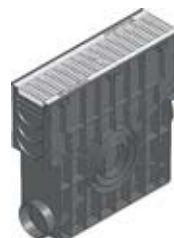
Avaloir avec panier PVC et grille caillebotis mailles 30x10, galva, agrée passage VL, montée et clavetée
