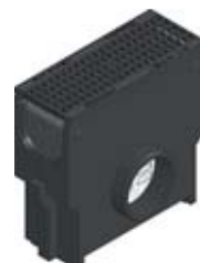
Avaloir avec panier galva et GUGI caillebotis fonte, mailles 16x24, noire, classe C 250, montée et clavetée
