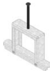
Clavette de fixation avec vis
