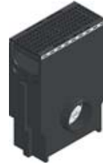
Avaloir avec panier galva et GUGI caillebotis fonte, mailles 15x22, noire, classe C 250, montée et clavetée
