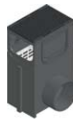
Avaloir avec panier galva, uniquement pour caniveau type 01, raccordement latéral DN 315, et grille GUGI caillebotis fonte, mailles 14x26 mm, noire, classe C 250, montée et clavetée
