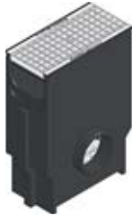
Avaloir avec panier galva et grille caillebotis mailles 30x30, galva, classe B 125, montée et clavetée
