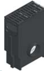
Avaloir avec panier galva et grille fonte à fentes 2x85x19, noire, classe C 250, montée et clavetée
