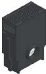
Avaloir avec panier galva et grille fonte à fentes 18x6, noire, classe C 250, montée et clavetée
