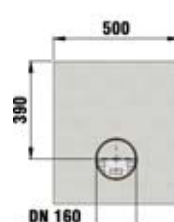
Avaloir, vue détaillée
