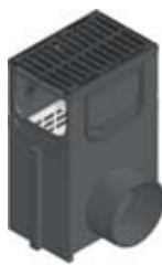
Avaloir avec panier galva, uniquement pour caniveau type 01, raccordement latéral DN 315, et grille fonte, à fentes 2x127x18 mm, noire, classe B 125, montée et clavetée
