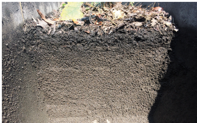
DRAINFIX CLEAN filterkoek, München, na 2 jaar in gebruik en een dagelijkse verkeersintensiteit van 24.000 voertuigen
