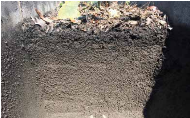
DRAINFIX CLEAN Filterkuchen, München, nach 2 Betriebsjahren und einer DTV von 24.000 Fahrzeugen
