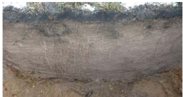
Trennscharfer Übergang von der Sedimentauflage zum Filter mit lokal eng begrenzten Einmischungen durch Bodenwürmer in 2 m Abstand vom Zulauf (3 Jahre nach der Sanierung).
