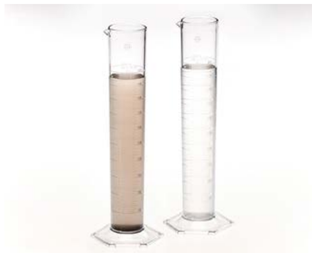
Straßenablauf vor und nach der Behandlung mit dem Filtersubstrat CARBOTEC .
