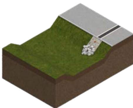
Versickerungsmulde ohne technischen Filter
