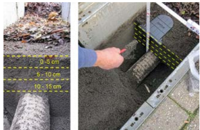
Probenahme zur Bestimmung der Zinksättigung des Filtersubstrats.
